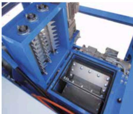
Mecanism auxiliar de dechidere pentru a usura întreținerea și reparatile
